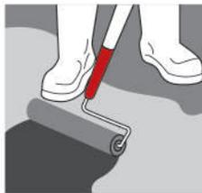
Aplica 2 capas de **Sika® EpoxyProtec**, utilizando un rodillo de felpa de pelo corto de 3/8\"/>
