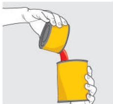
Si deseas un acabado con color, utiliza **Sikafloor® EpoxyColor**. Agrega 1 lata al componente A del **Sika® EpoxyProtec** (Resina) antes de mezclar con el componente B.
